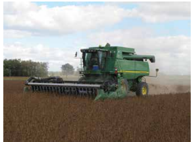
Photo 2-8 – Moissonneuse-batteuse munie d'un rabatteur avec soufflerie pour limiter les pertes
