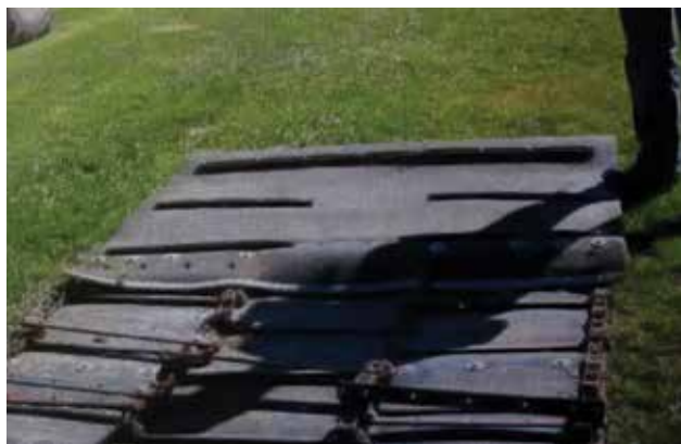
Photo 7-1 – Utiliser des courroies en caoutchouc pour éviter que les fibres des plants s’enroulent autour des axes, des chaînes, etc. Gracieuseté du gouvernement du Manitoba
