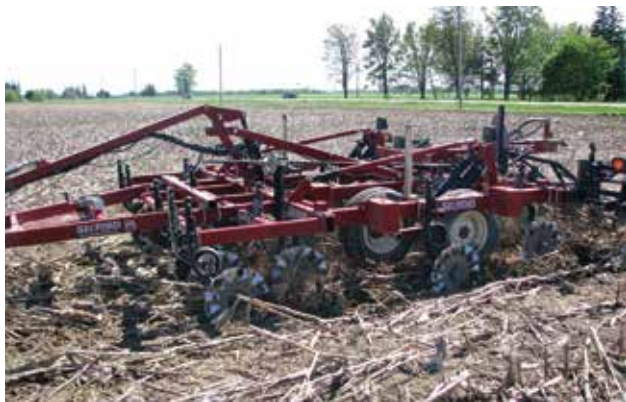
Photo 1-1 – Outils de travail du sol vertical qui brisent légèrement la structure du sol et le mélangent aux résidus
