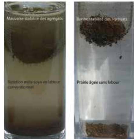
Photo 8-12 – Démonstration de la stabilité des agrégats dans une bonne et une mauvaise rotation des cultures
