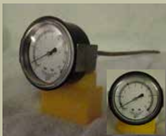
Figure 3.4 Exemple de manomètre calibré en pouces de colonne d'eau pour mesurer la pression statique sous le plancher
